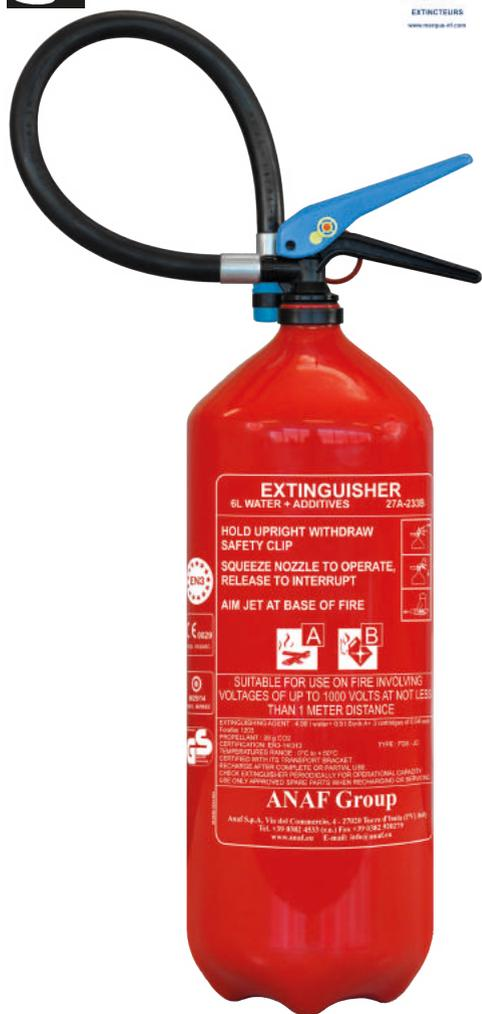
FG6-J et FG6-JF sont des extincteurs à pression auxiliaire à eau pulvérisée avec additifs avec cylindre en aluminium.
