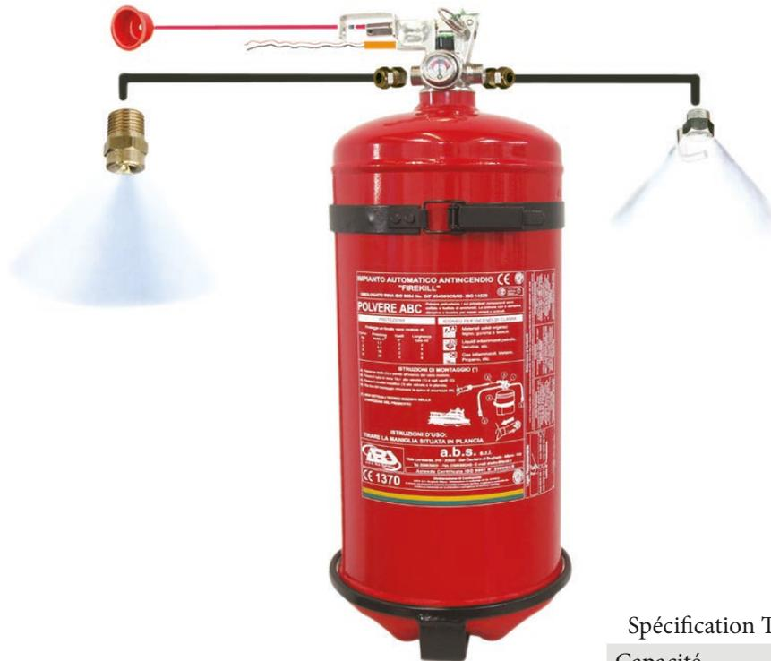
FIREKILL 1-3-6-9-12 sont des systèmes fixes d'extinction à poudre ABC avec corps de vanne en laiton nickelé, buses, commande manuelle à distance, ampoule thermosensible et d'un pressostat.
