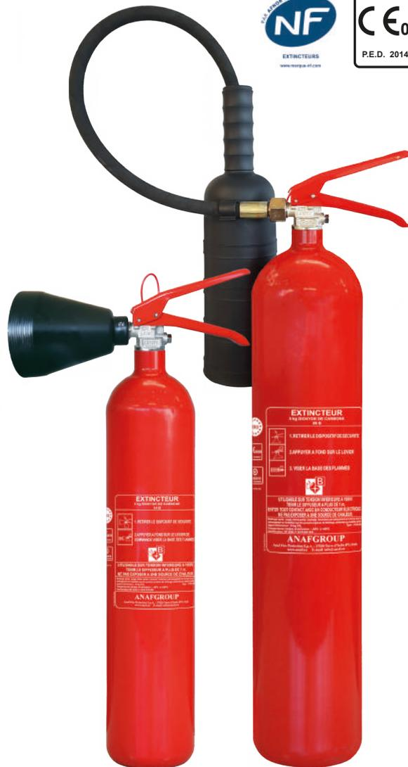
CS2-A et CS5-A sont des extincteurs au dioxyde de carbone avec corps de vanne en laiton nickelé et diffuseur. Les températures d'utilisation de -30°C à + 60°C, rendent l'extincteur adéquat aussi dans les pays à températures extrêmes.
