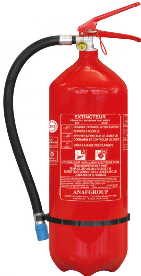
FS6-LH est un extincteur à pression permanente à eau pulvérisée avec additifs avec cylindre en aluminium et manomètre. Températures d'utilisation de 0°C à + 60°C. La totalité des extincteurs est contrôlée par un système électronique de détection des fuites à base d'hélium.
